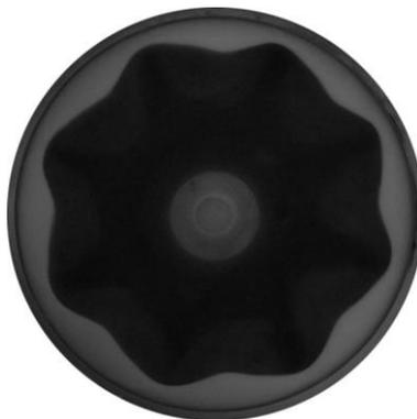
Рис. 1. Рельеф на поверхности сыпучей среды в либрирующем цилиндре:  $d = 0.09$  мм,  $\nu = 5.2$  сСт,  $f_r = 4.5$  об/с,  $f_l = 1.0$  Гц,  $\varepsilon = 0.25$ ,  $h_0 = 1.00$  см
