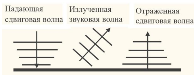
Рисунок 1 – Генерация звука при отражении сдвиговой волны от плоской границы
