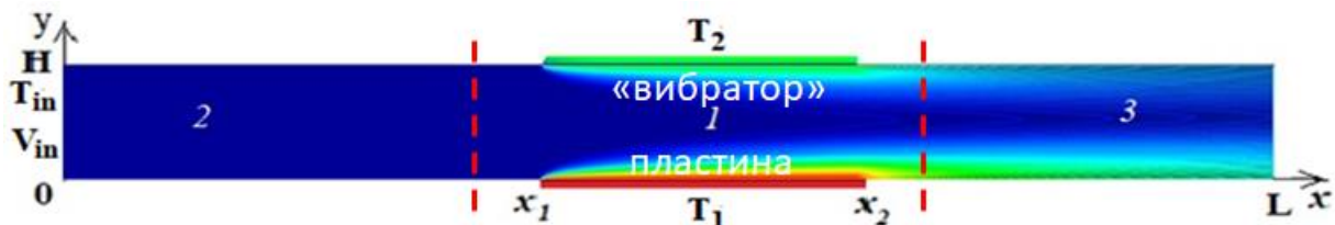
Рис. 1. Геометрия расчётной области и изотермы ( V_{in}=0.1 м/с, T_{in}=300^\circ К, T_1=350^\circ К, T_2=325^\circ К, воздух).
